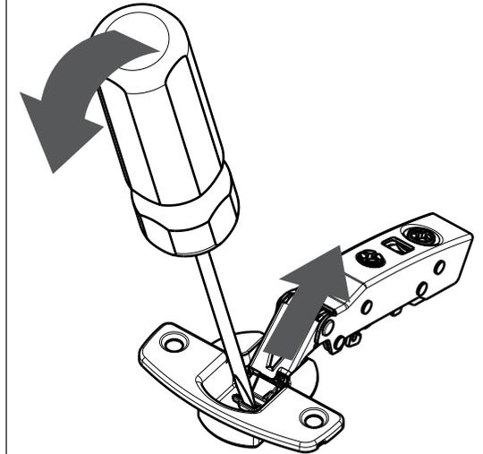
**4** Scharnier langsam schließen und gleichzeitig mit sanftem Druck in Richtung Hebel schieben.
