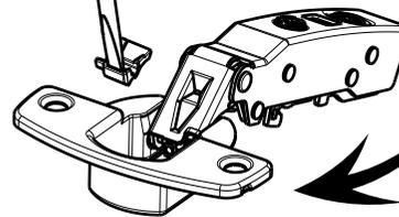
**3** ÖWB so weit wie möglich unter den Hebel schieben.
