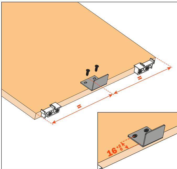
2) Befestigung des Magneten am Schrankboden.
