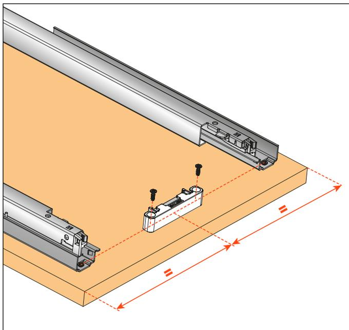
3) Arretierung des Ausziehbodens im max. geöffneten Zustand.
